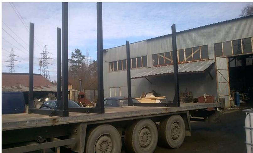
Рисунок 3 – Пример сварных, П-образных (перевернутых) коников
